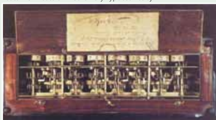
Pascaline – Pascalův mechanický výpočetní stroj
